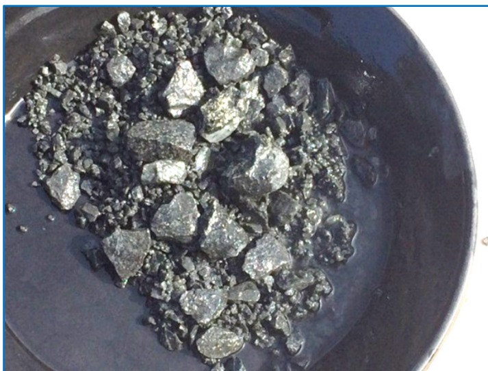
Sulphide lode 3.86g/t Au (BBRC0012; 193m-194m)
